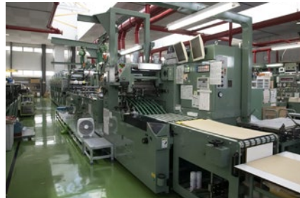
孔あけ、ミシン目(縦目・横目)、抜き加工に対応する6色フォーム輪転機
