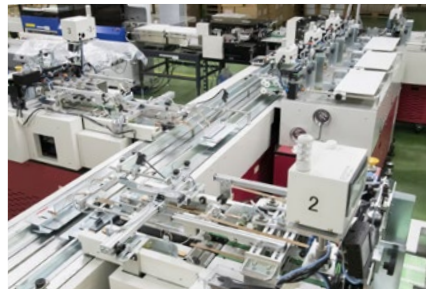
孔あけ、ミシン目(縦目・横目)、抜き加工に対応する6色フォーム輪転機
