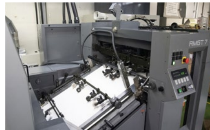
品質検査用にインクジェットプリンターで1枚ずつ識別番号を印字しながら給紙するフィーダー
